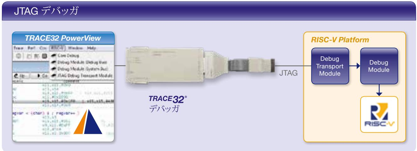
ローターバッハ社は、新しいRISC-Vデバッグを2017年11月に発売しました。現在サポートされている最初のチップは、E31コアコンプレックス(32ビット)と、E51(64ビット) SiFive社のCore Complexです。
