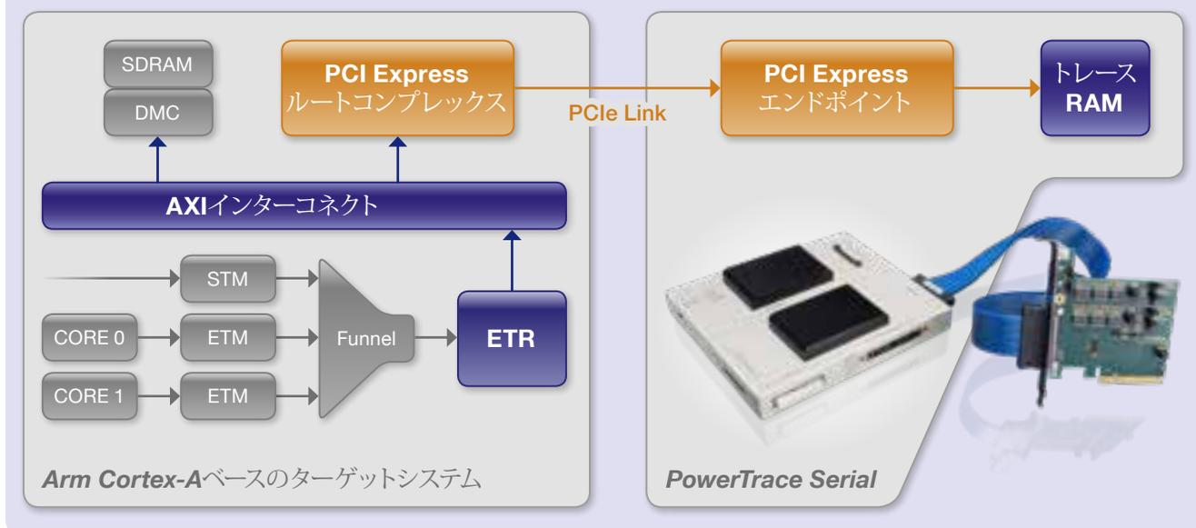
チップにPCIeインターフェースが装備されている場合は、外部トレースツールを使用してトレースデータの記録と解析に使用することができます。以前からローターバツハ製品を導入しているお客様は、既にArm Cortex-A®やNXP PowerアーキテクチャーベースのQorIQ®プロセッサに対してこのトレース方法を使用しています。
