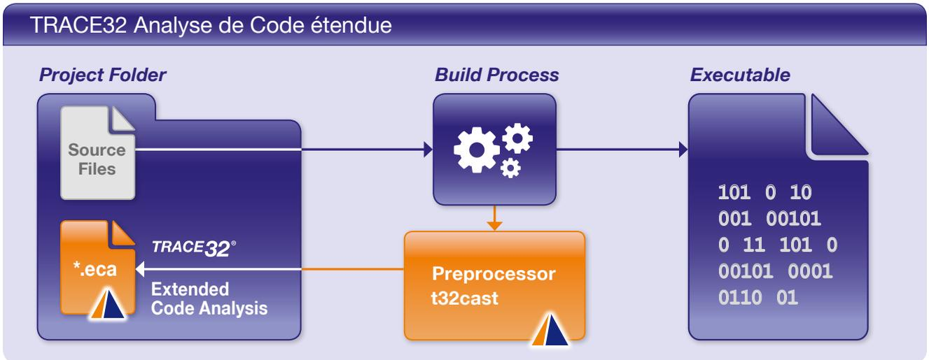
C'est possible, si le compilateur et l'application sur laquelle l'analyse de couverture MCDC est effectuée proviennent du même prestataire. Le compilateur peut ainsi inclure les nouvelles informations nécessaires sur la structure et la position de chaque décision du code source dans les informations de debugge. La société AdaCore (voir [2]) offre ce type de solution. En plus de cela, Adacore offre aussi une solution d'émulation d'une cible générant les données de trace.
