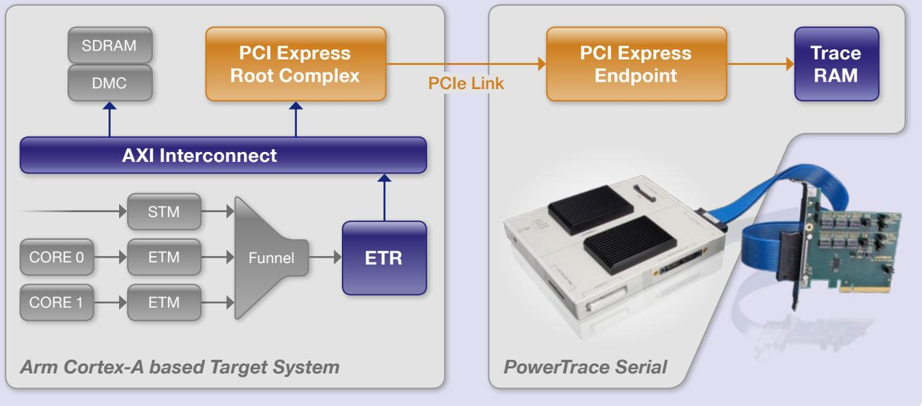
Lorsqu'un composant est équipé d'une interface PCIe, il est possible de l'utiliser pour enregistrer et analyser les données de trace grâce à un outil externe de trace. Plusieurs clients Lauterbach l'ont adopté en avance de phase, sur des architectures Arm Cortex-A® ou bien sur des processeurs NXP Power QorIQ®.
