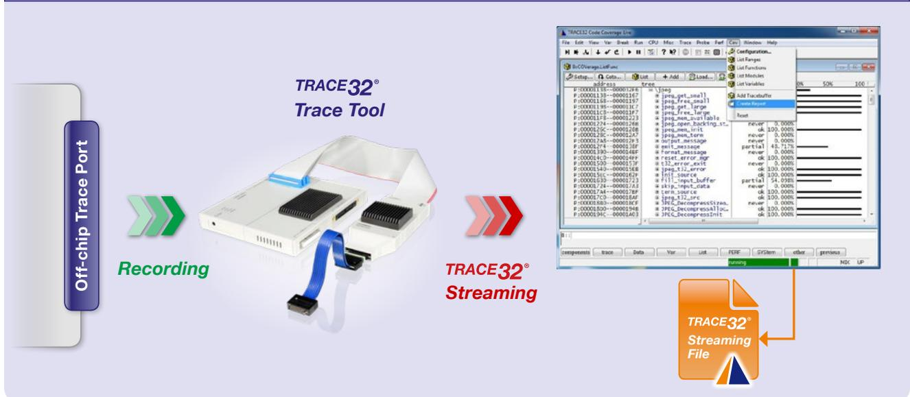
Real-time Profiling (RTS) est le nom donné par Lauterbach au mode d'enregistrement des données de trace à la volée vers le pc « host » et leurs analyses immédiates. Ceci permet un suivi en direct à l'écran des résultats d'analyse de la couverture de code. Fin 2017, le mode RTS, qui peut être déjà utilisé pour l'Arm-ETMv3 depuis 2009, a été déployé sur plusieurs protocoles de trace. Le tableau « RTS - Supported Trace Protocols » montre un aperçu de tous les protocoles de trace supportés.
