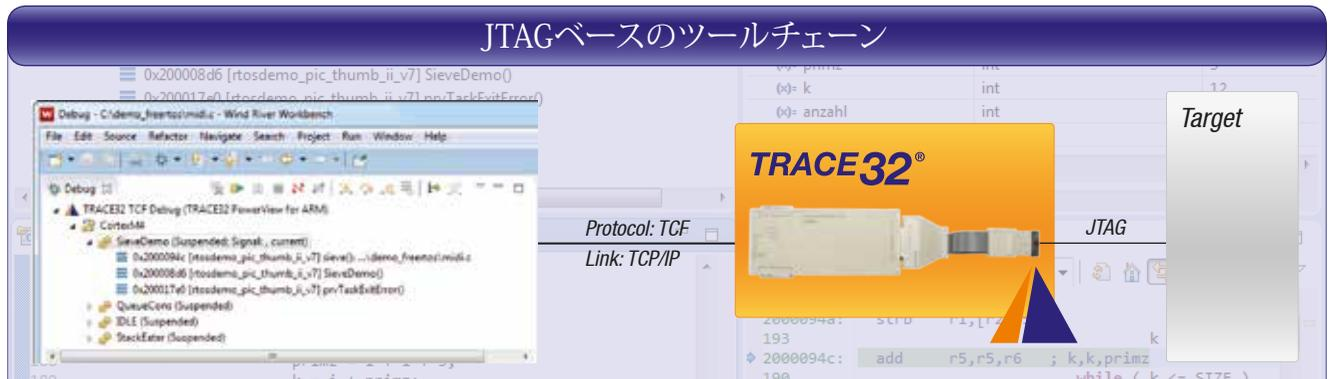
2015年10月以降、TRACE32はTCFエージェント機能も提供しています。Wind River WorkbenchまたはEclipseデバッガをIDEとして、TRACE32をデバッグバックエンドとして使用することができます。
