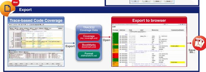
コードカバレッジ解析用のデータを収集するために、トレースツールは、システムテスト中に実行された命令に関するすべての情報を記録します(記録)。記録されたトレース情報は、コードカバレッジデータベースでTRACE32 PowerViewによって管理されます。これにより、ユーザーはコードカバレッジの結果を数多くの方法で解析および表示できます(確認)。
