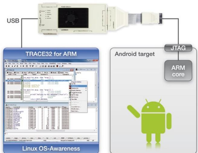
Fig. 5: En mode stop, le débogueur communique directement avec le processeur de la plate-forme matérielle du système Android.
