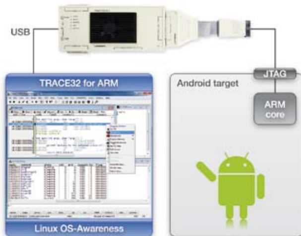
图 4: 在停止模式调试中, 调试器可直接与安卓硬件平台上的处理器通讯。
