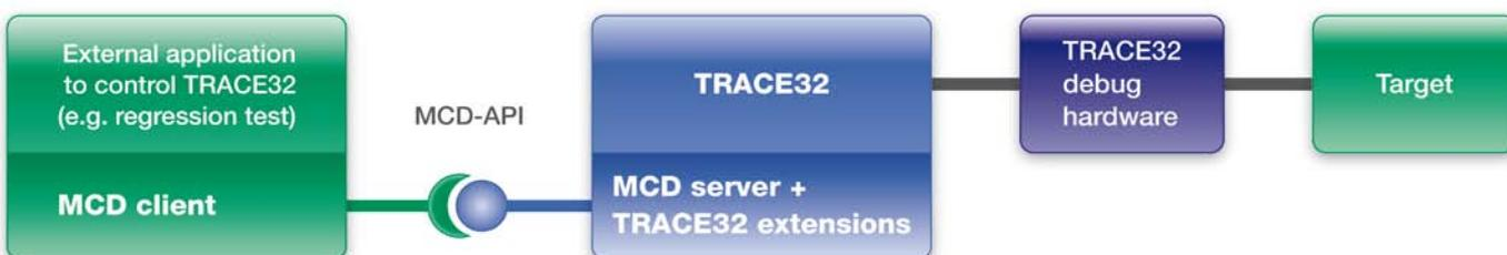
Bild 17: Über die Remote-API kann TRACE32 durch eine externe Anwendung gesteuert werden.
