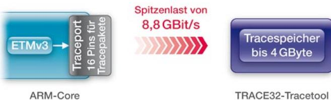
Bild 3: Das Tracetool für die parallele ETMv3 erlaubt eine Datenrate von 8,8 GBit/s bei 16 Pins für die Tracepakete
