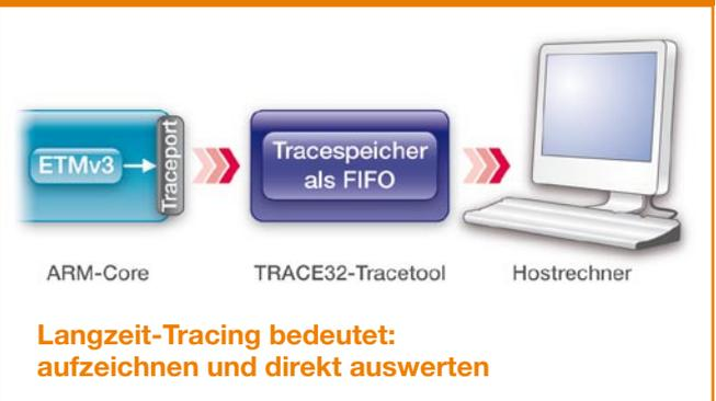
Ein Langzeit-Tracing wird dadurch realisiert, dass die Tracepakete schon während der Aufzeichnung auf den Hostrechner übertragen und dort ausgewertet werden. Hier funktioniert der Tracespeicher des TRACE32-Tracetools quasi nur noch als FIFO.
