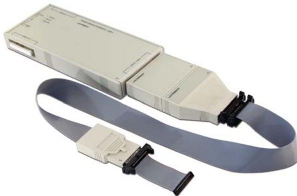
Bild 24: POWER DEBUG INTERFACE / USB 2 mit einer CombiProbe.
