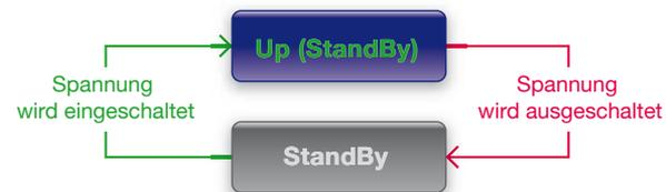
Bild 10: Statt eine Fehlermeldung auszugeben, wartet der Debugger nach dem Abschalten der Spannung auf ihr Wieder-Einschalten.
