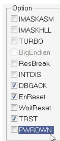
Bild 9: Die Option PWRDWN regelt, ob die Stromsparmodi beim Debugging ignoriert oder beachtet werden.
