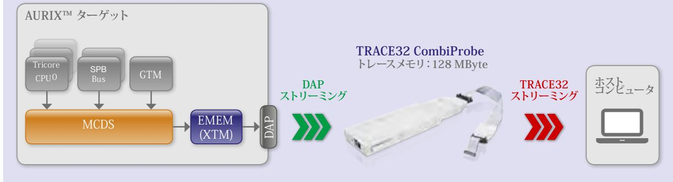
ローターバッチは2016年10月にInfineonのAURIX™ファミリ用にCombiProbe TriCore DAPの提供を開始しました。TRACE32はAGBTインタフェースが装備されていないターゲットハードウェアのAURIXユーザにも包括的なランタイム解析を提供します。
