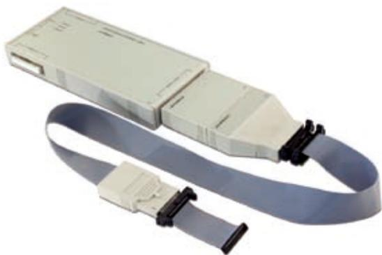
図 24: CombiProbe を取り付けした POWER DEBUG USB2
