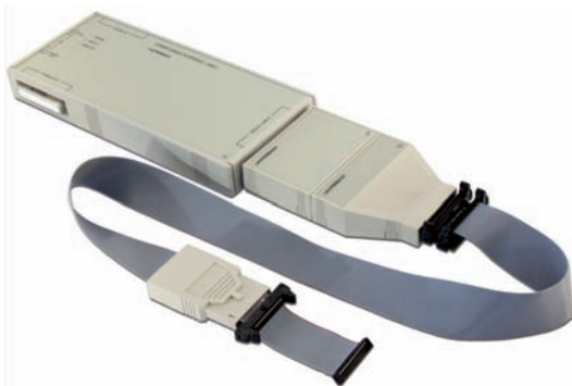
Bild 9: Power Debug Module und CombiProbe als kostengünstiges Entwicklungswerkzeug für die Cortex-M Serie
