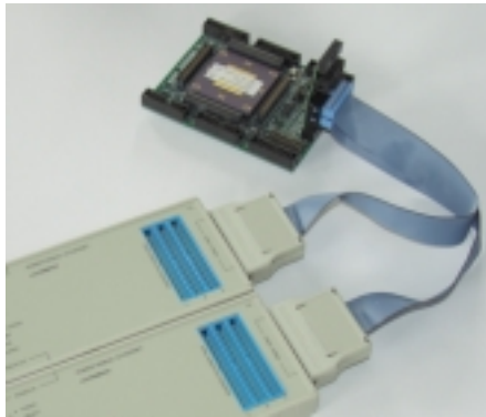
Bild 1: Zwei unabhängige TRACE32-ICD Debugger, die ein SoC mit zwei Cores über eine gemeinsame JTAG-Schnittstelle debuggen
