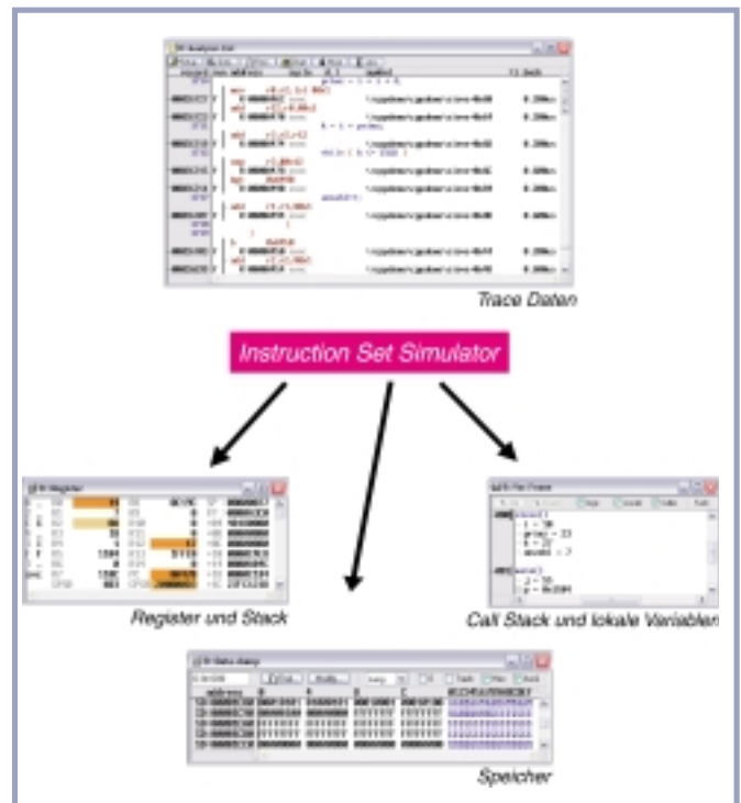
Bild 12: CTS stellt mit Hilfe des Instruction Set Simulators die Inhalte von Registern, Speicher und Stack für jeden Eintrag im Tracespeicher noch einmal her.
